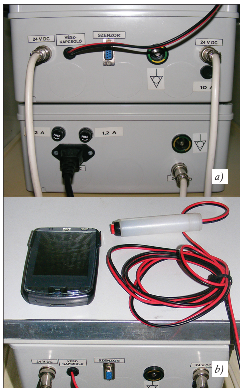
5. ábra. A kísérleti berendezés vezérlőelektronikája és tápegysége (a), valamint a palmtop és a vészkapcsoló (b)
